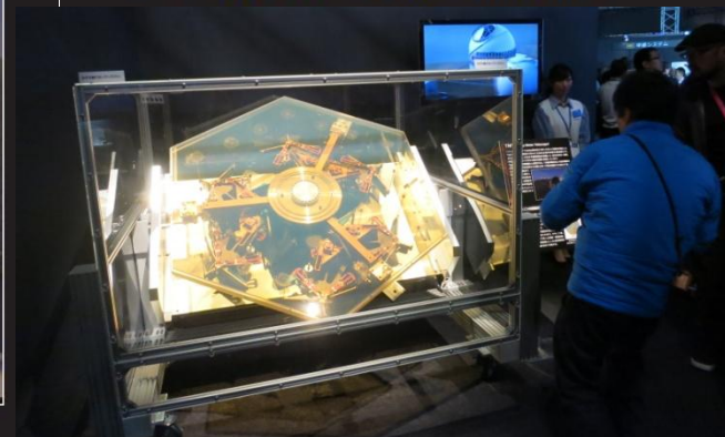
492枚の分割鏡を敷き詰めた主鏡の構成図
