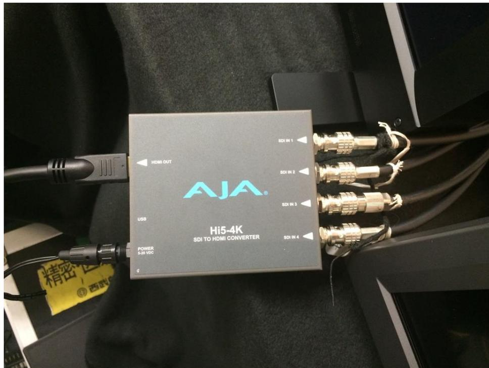
\*3G SDI x4を1本のHDMIへ変換し1台の4Kモニターに接続、それを4台分接続する
